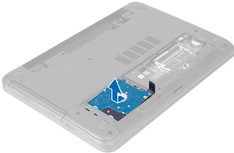
5. Retire el tornillo que fija el soporte de la unidad de disco duro al disco duro y extráigala.
