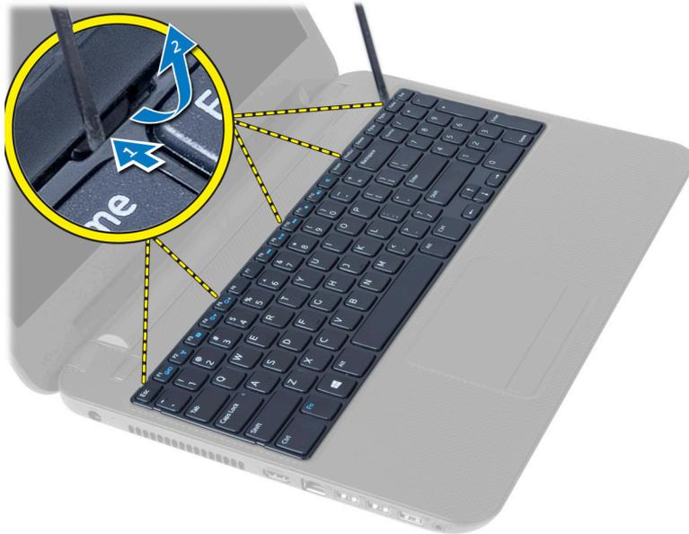
4. Deslice el teclado hacia el ensamblaje de la pantalla y dé la vuelta al teclado sobre el ensamblaje del reposamanos.
