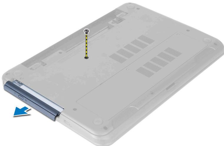
4. Extraiga los tornillos que fijan el soporte la unidad óptica al ensamblaje de la unidad óptica.
