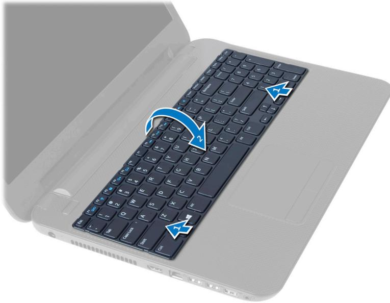
5. Desconecte el cable del teclado del conector en la placa base y retire el teclado del ensamblaje del reposamanos.
