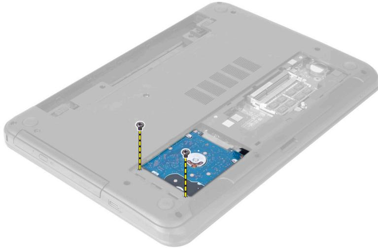
4. Deslizar el disco duro en la dirección que se muestra y levantar la lengüeta para extraerlo del equipo.
