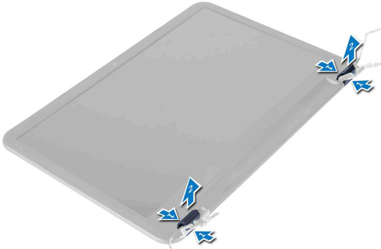
4. Haga palanca sobre los bordes del embellecedor de la pantalla. Extraiga el embellecedor de la pantalla del equipo.
